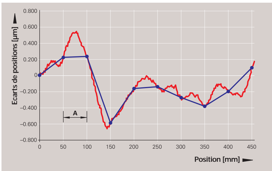
Fig. 2: Points de correction pour compensation linéaire ponctuelle des erreurs
